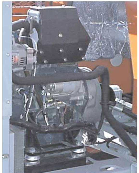
Es un soporte muy adecuado para aquellos motores donde no sea físicamente posible instalar los soportes antivibratorios a la misma altura del cigüeñal.
